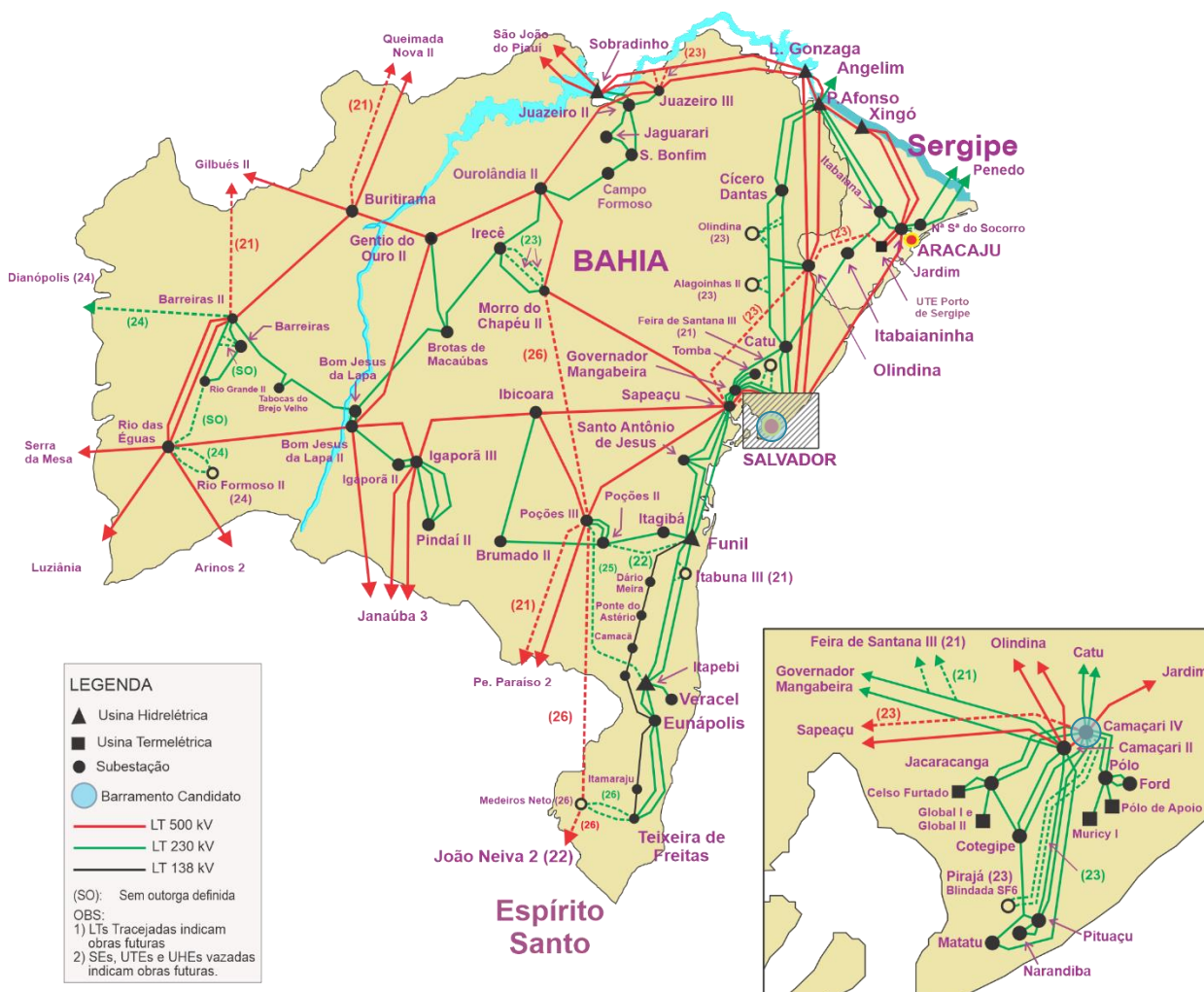
Figura 8-11: Sistema elétrico do estado da Bahia
