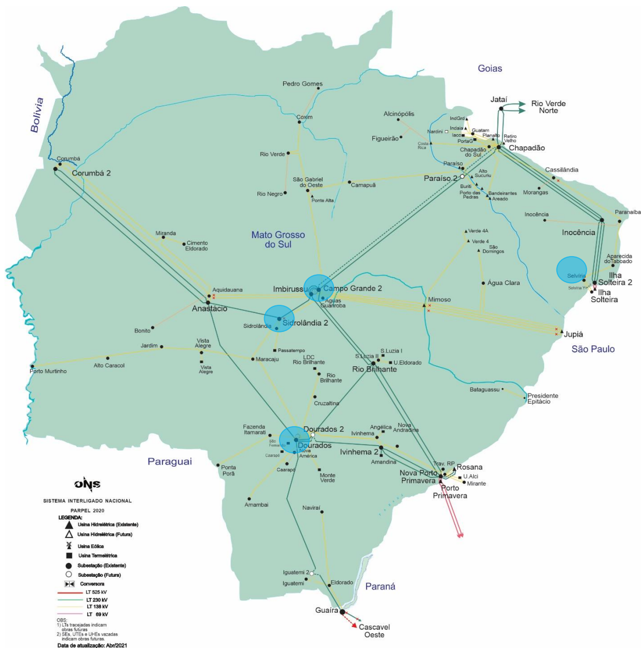
Figura 8-4: Sistema elétrico do Mato Grosso do Sul
